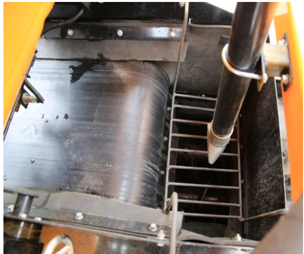
Стабильная система ленточной подачи
