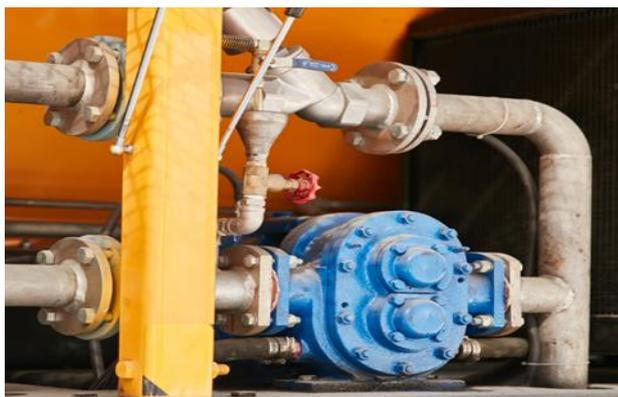
**Насос теплого асфальта охлаждающей жидкости**
